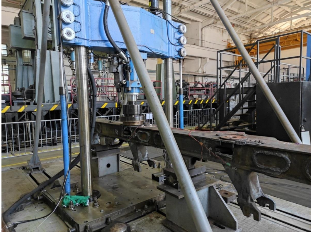
Рисунок А.3 – Испытания боковой балки рамы тележки на стенде для испытаний на прочность конструкций и элементов машин
