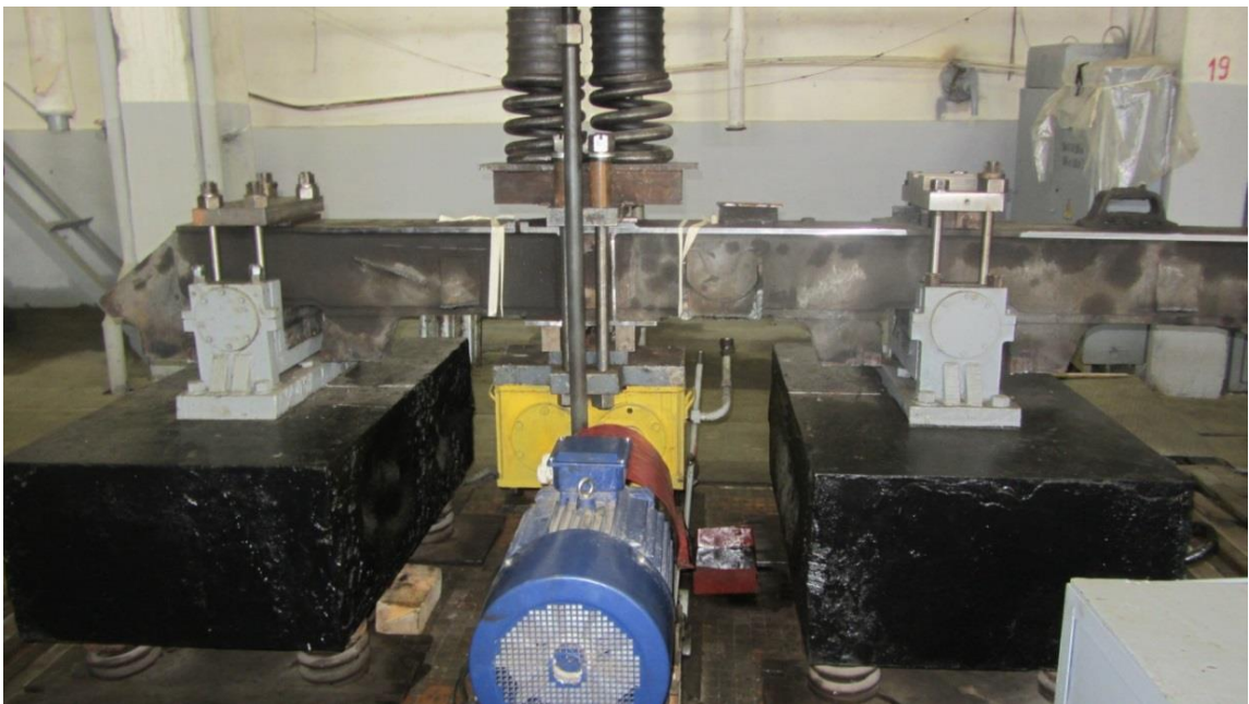
Рисунок А.2 – испытания на усталость боковой рамы тележки тепловоза на стенде резонансного типа
